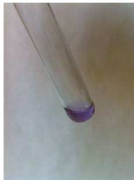
Résultat après ajout de 1 goutte de sulfate de cuivre à 1% et 5 gouttes de soude à 0,1 mol/L Coloration violette (test positif)
